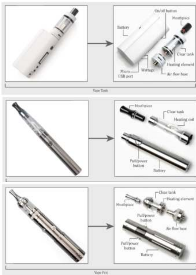
Figura 2. Componentes del cigarrillo eléctrico.
